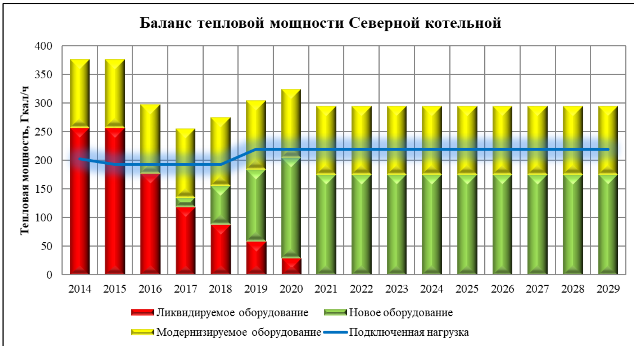
Рисунок 6.11 - Баланс мощности и нагрузки котельной Северная по сценарию 1 и сценарию 2 (до 2028 года включительно)
